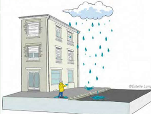
Accumulation de l'eau sur les surfaces imperméables et manque d'infiltration
